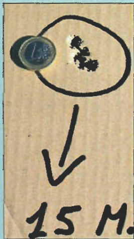
A sinistra: rosata di cinque colpi, sparando in appoggio, alla distanza di 15 metri.
